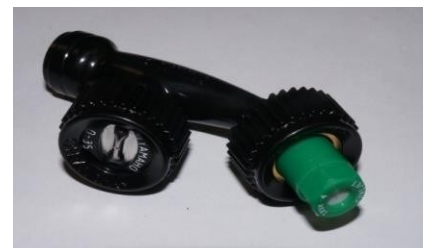
Figura 6. Ejemplo de cómo se vería instalado en cuerpo de doble boquillas que viene de fábrica junto con la aspersora de motor.
