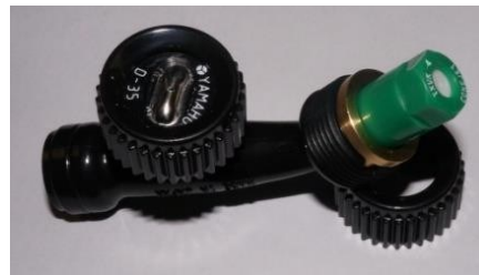
Figura 6. Ejemplo de cómo se vería instalado en cuerpo de doble boquillas que viene de fábrica junto con la aspersora de motor.
