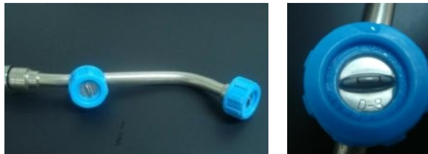
Figura 2. Porta boquillas doble con boquilla D3 de doble orificio de salida para aspersora Shindaiwa ES726.
